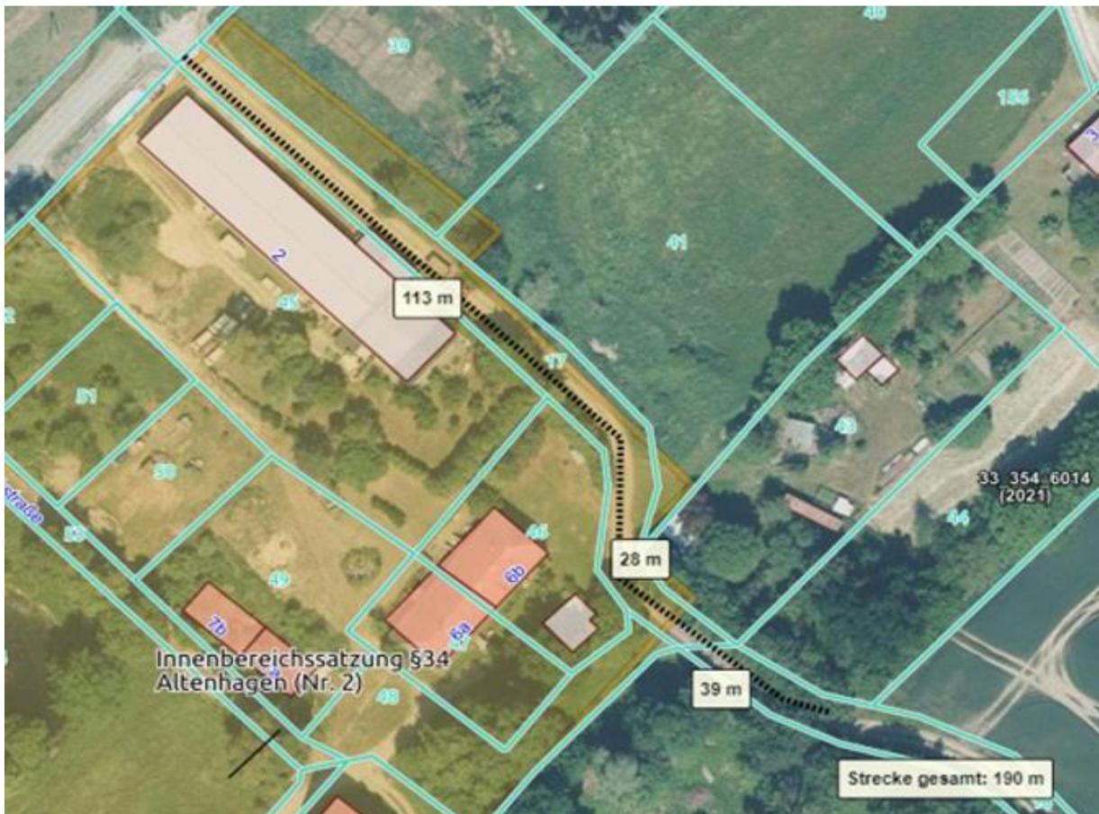
Die Wegetrasse im Bestand ist in großen Teilen in Natursteinpflaster und darüber hinaus mit Betonplatten befestigt. Das Baufeld ist ca. 190 lfd. lang und soll die Wohngrundstücke und die angrenzenden landwirtschaftlichen Flächen in einer Breite von 3,50 m verkehrstechnisch erschließen. Als Ausbauart ist die Befestigung mit einer Betonspurbahn im Maßnahmenplan festgelegt.
