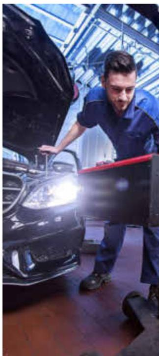
Im Licht-Test, den Kfz-Werkstätten in ganz Deutschland anbieten, werden alle Beleuchtungselemente des Fahrzeugs überprüft.
